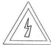
Fig. 10 Merking av hovedstrømbryter (rødt lyn, hvit bunn, blå bord) 60 mm sider
